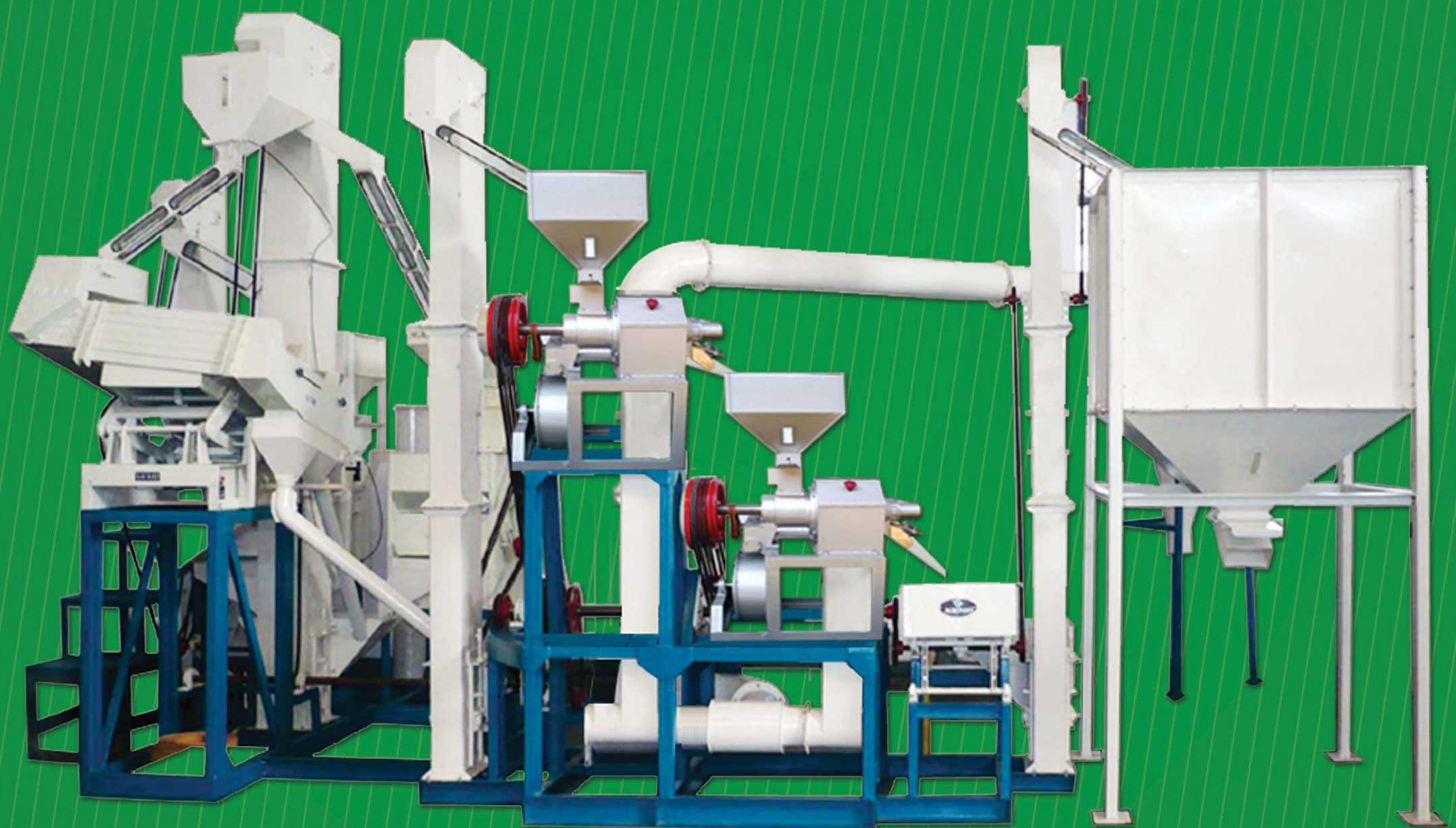
AGRINDO, Integrated Rice Milling Unit atau populer disebut Mesin Penggilingan Terpadu 1,3 – 1,5 Ton/jam Gabah Kering Giling (GKG) terdiri atas Mesin Pembersih Gabah, Mesin Pengupas Kulit Gabah, Separator 5 Talam, 2 unit Mesin Poles (2Fase), Mesin Pengayak Menir, Tangki Penampung Beras dan beberapa Elevator yang dirangkai menjadi satu kesatuan Unit, melalui perantara Poros Transmisi yang digerakkan Motor Diesel 60HP
