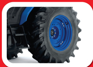
BESI COR PEMBERAT PADA RODA BELAKANG Keseimbangan beban traktor
