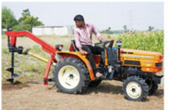
Aplikasi Ini digunakan untuk menggali lubang ukuran kecil untuk memasang pembatas, seperti pagar dan rambu.
